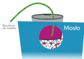
**2** Una vez dentro, introduzca una manguera para aspirar el mosto muestra del contenido. (la cesta separa el contenido y facilita el acceso al líquido).
