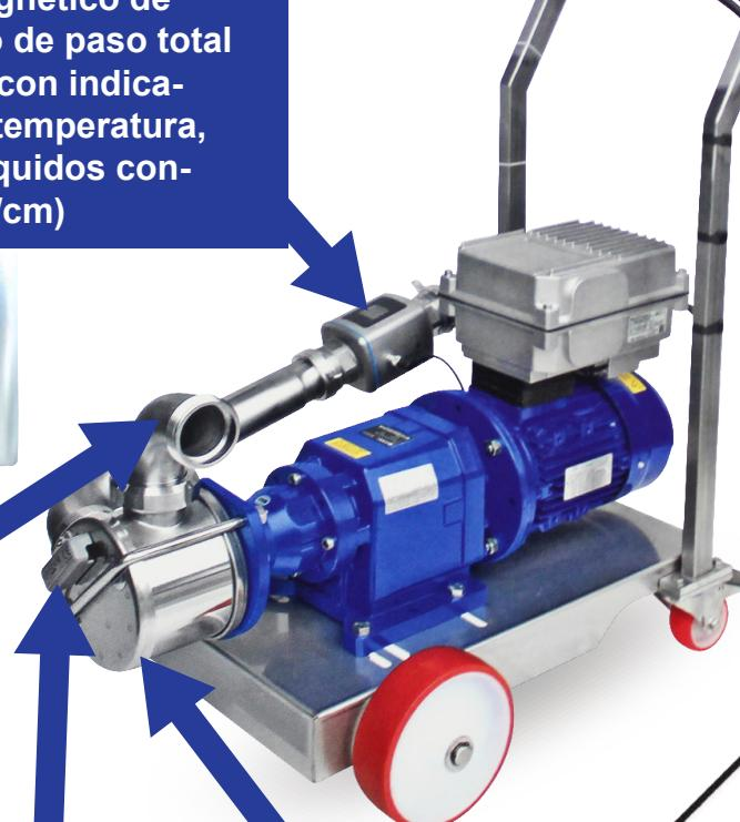
**sensor de temperatura de parada en seco en el cuerpo de la bomba**
