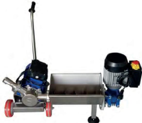
Diseñada para el transporte del producto semisólido, derivado del procesado tanto de molinos trituradores (por ejemplo M100), como de desgranadoras, trituradoras (por ejemplo ENO 15 o procesado con granada).
