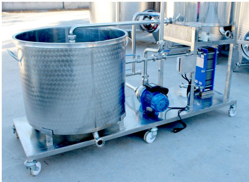
La olla inferior lleva incorporado un doble fondo extraíble fabricado con chapa perforada de acero INOX 2 mm espesor, perforaciones de 2 mm en toda su superficie. La rejilla nos va a permitir la filtración del macerado
